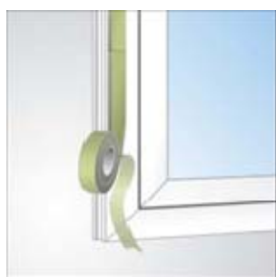
Stumpfstoß bei der Fenstermontage
