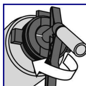
AA210 Spray Nozzle een kwartslag draaien.
