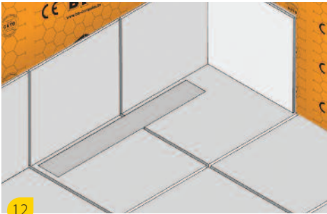
Wandtegels plaatsen / Pose du carrelage mural / Wandfliesen anbringen / Fixation of the wall tiles.
